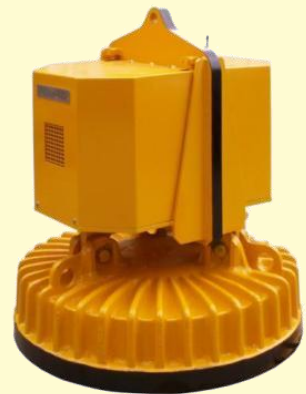
Autonome Elektromagnete mit mitgeführtem Stromgenerator
