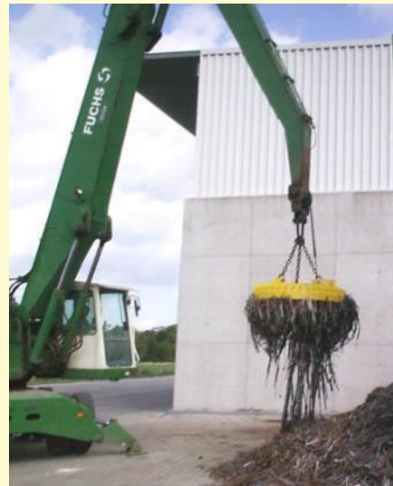
Elektromagnete an Hydraulikbaggern
