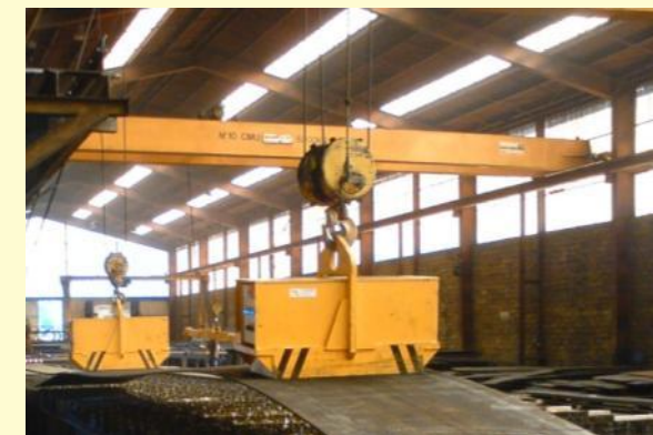
Autonome Elektromagnete mit mitgeführten Akkus und Steuerung
