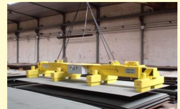
Teleskoptraversen mit Permanentmagneten
