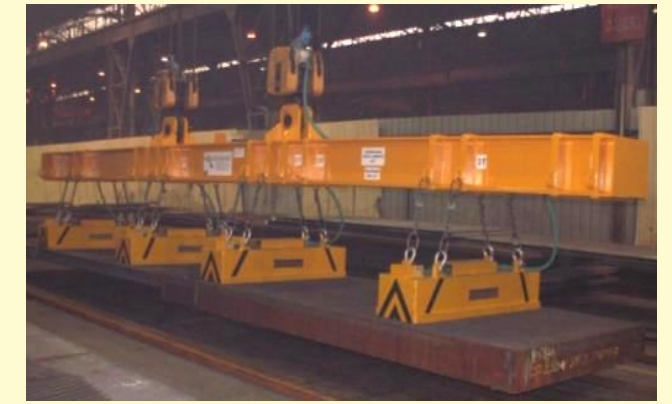
Traversen mit rechteckigen Elektromagneten
