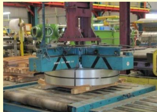
Handhabung mit Elektromagneten mit vertikaler Achse
