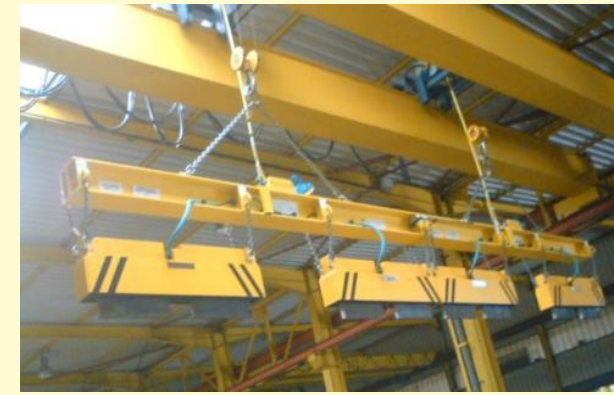
Traversen mit Elektromagneten mit beweglichen Polen
